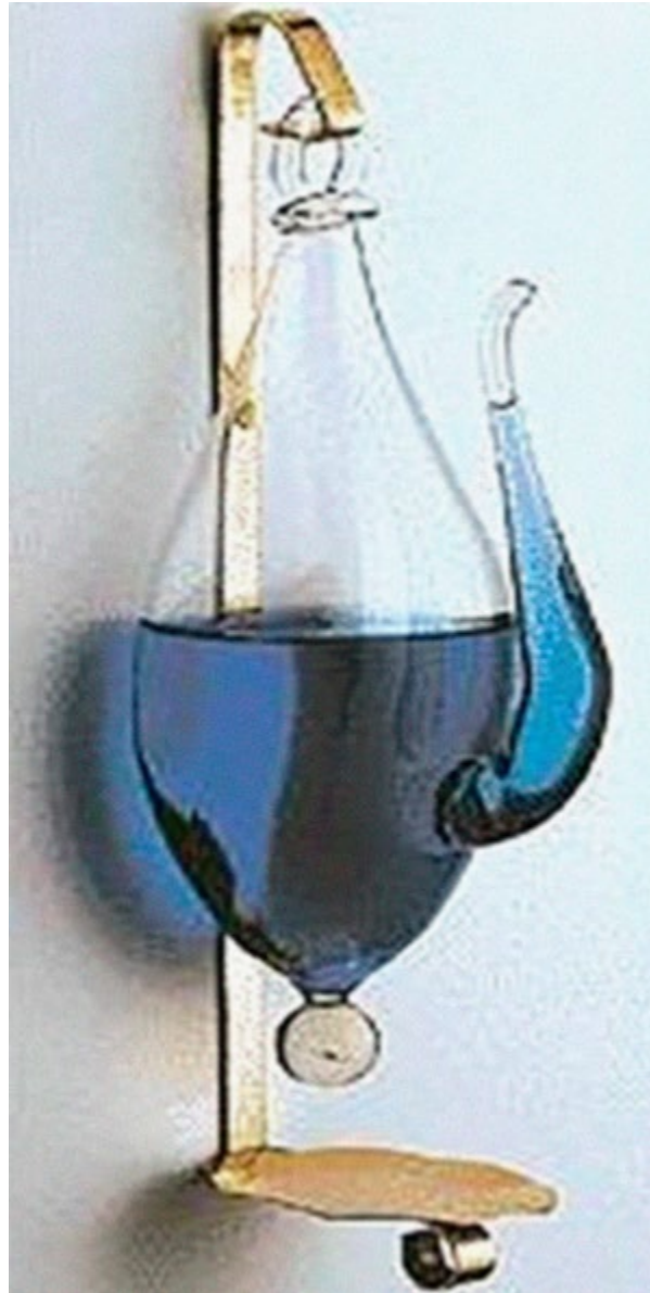
Figura 5. “Vidrio de tormenta”, conocido como “barómetro de Goethe” que permitía conocer las variaciones de presión atmosférica
